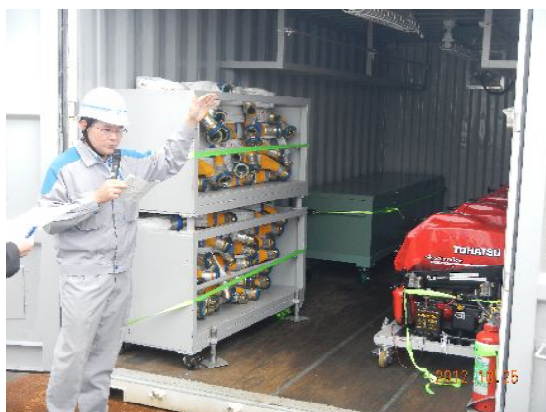
【写真③】：仮設ポンプ・ホース
